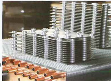
Geometrie 32x27,7mm für Rohre \varnothing 12 \times 0,4 \text{ mm} .
